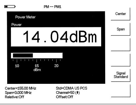
Figure 6-3. Sample Power Meter Display
